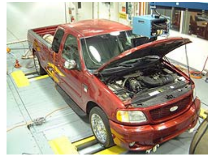
Test d'un véhicule H 2 -MCI
